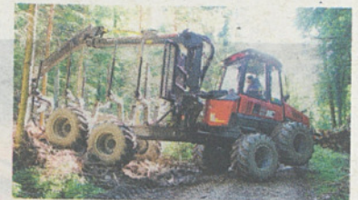
Beim Kurvenfahren mit dem Forwarder hebt Urs Küpfer die hinterste Achse an.
